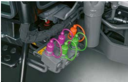
În partea din față sunt disponibile până la patru conexiuni hidraulice și un retur cu debit liber.
