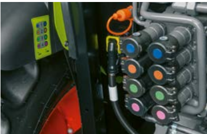
Conexiunile din spate sunt ușor de identificat datorită codului de culori și a autocolantelor adiacente.
