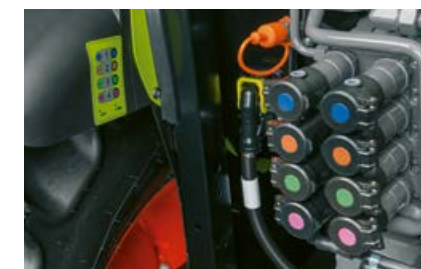
Las conexiones en la parte trasera se reconocen fácilmente por su codificación de colores y los adhesivos colocados al lado.
