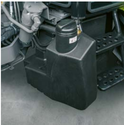
El depósito de diésel de 105 l y el depósito de urea de 10 l ofrecen un alcance suficiente incluso en jornadas laborales largas e intensivas.
