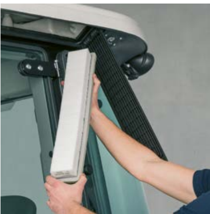
El filtro de aire de la cabina ofrece un fácil acceso para ser limpiado desde el exterior y garantiza, en todo momento, un clima fresco.
