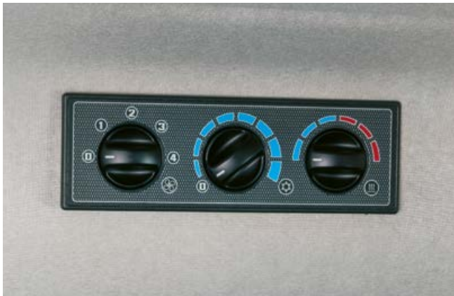
El manejo del equipo de ventilación está muy a mano en el lado derecho del bajotecho.
