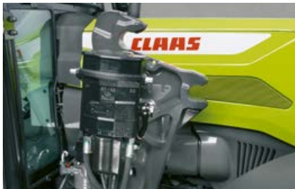
Sistema FITLOCK para el rápido montaje / desmontaje y acoplamiento rápido MACH para conexiones eléctricas e hidráulicas.
