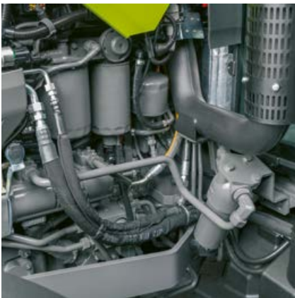
Los filtros en el motor ofrecen un buen acceso incluso con un soporte para el cargador frontal.
