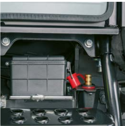
El ELIOS 3 le facilita la jornada con muchas soluciones inteligentes, como p.ej. polos de la batería desplazados al lado derecho de la cabina.
