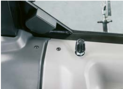
El caudal máximo del mando de control mecánico-hidráulico nr. 3 puede ser limitado con una manipulación en la cabina.
