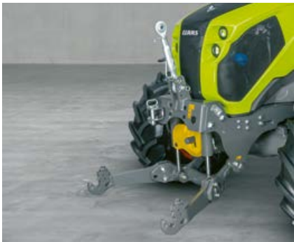
Le relevage avant de 3,2 t en option et la prise de force avant assurent la polyvalence de l'ELIOS Série 2.
