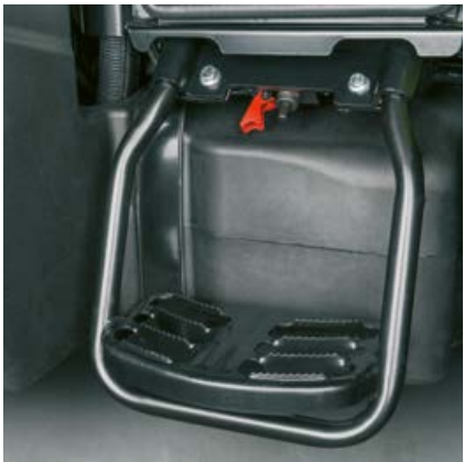
Le coupe-batterie est installé à portée de main au niveau du marchepied gauche (sauf ELIOS 2.75).
