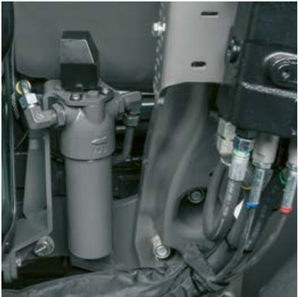
Les filtres du moteur sont également faciles d'accès avec le prééquipement chargeur monté.
