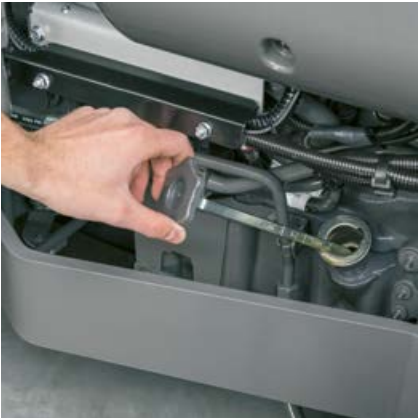
Le contrôle du niveau d'huile et l'appoint d'huile peuvent s'effectuer capot fermé sur le côté droit de l'ELIOS Série 2.
