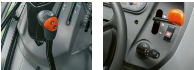
Vous disposez au choix d'un doubleur mécanique à droite du volant ou d'un doubleur sous charge TWINSHIFT qui se commande avec le levier de vitesses.
