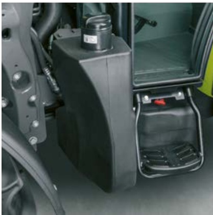
Il serbatoio carburante di 95 l e il serbatoio per l'ur-rea di 10 l assicurano sempre l'autonomia necessaria anche durante lunghe e intense giornate di lavoro.
