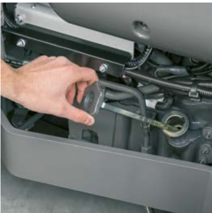
È possibile controllare il livello dell'olio e rabboccarlo a cofano chiuso sul lato destro dell'ELIOS 2.
