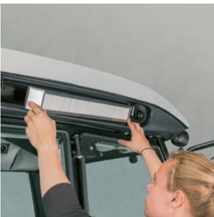
Si può raggiungere facilmente dall'esterno il filtro dell'aria in cabina per pulirlo ed avere sempre aria fresca e pulita.
