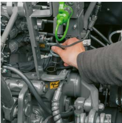
El nivel de aceite para el engranaje y la instalación hidráulica lo controla fácilmente en la parte trasera.
