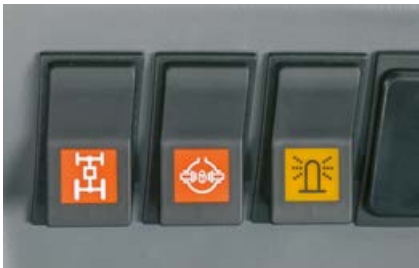
Conmutación eléctrica de la doble tracción y el bloqueo del diferencial: Mediante la desconexión de seguridad en base a la velocidad se evitan fallos de manejo.
