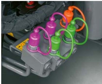
En la parte delantera derecha de la cabina están disponibles hasta cuatro conexiones hidráulicas, así como un retorno libre.
