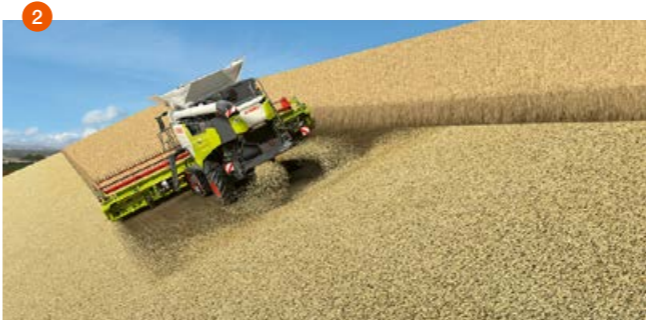
1 Sulle pendenze la direzione di lancio viene adattata automaticamente. 2 Il trinciato viene distribuito in modo omogeneo sull'intera larghezza di lavoro.
