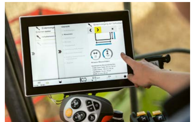
Immissione nel CEBIS delle dimensioni della vaschetta di perdita disponibile.
