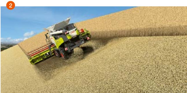
1 I bakket terræn tilpasses kasteretningen automatisk. 2 Snittematerialet fordeles ensartet over hele arbejdsbredden.
