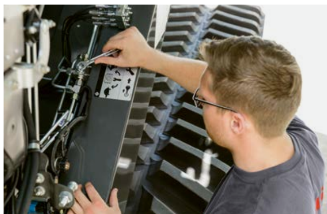
Du skifter manuelt mellem tærskecylinderreduktionsgearets to omdrejningsområder med en hydraulikventil.
