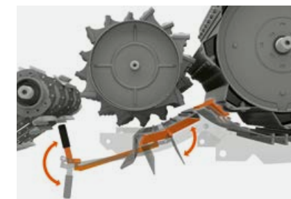
Forbroklapper kørner og fjerner avner.
