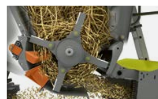
Przeciwostre i uchylny element dna w siekaczu słomy SPECIAL CUT
