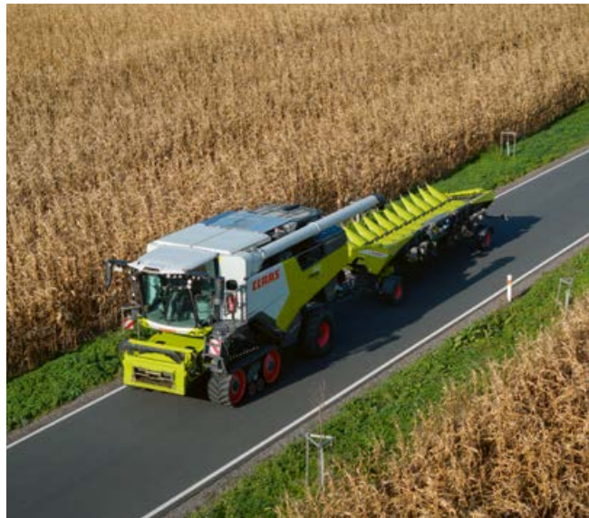
Wszystkie gąsienice TERRA TRAC nadają się do jazdy po drodze z prędkością maks. 30 km/h. Można z nich wygodnie korzystać jak w przypadku maszyn na kołach.
