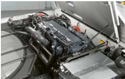
Les modèles TRION 760 et 750 sont équipés de moteurs six cylindres MAN de 12,4 l de cylindrée très efficaces, capables de délivrer jusqu'à 507 ch.
