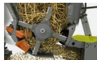
Gegenmesser und schwenkbares Bodenelement im SPECIAL CUT Häcksler
