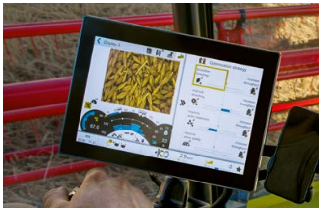
Intelligente Steuerung durch CEMOS AUTOMATIC über CEBIS
