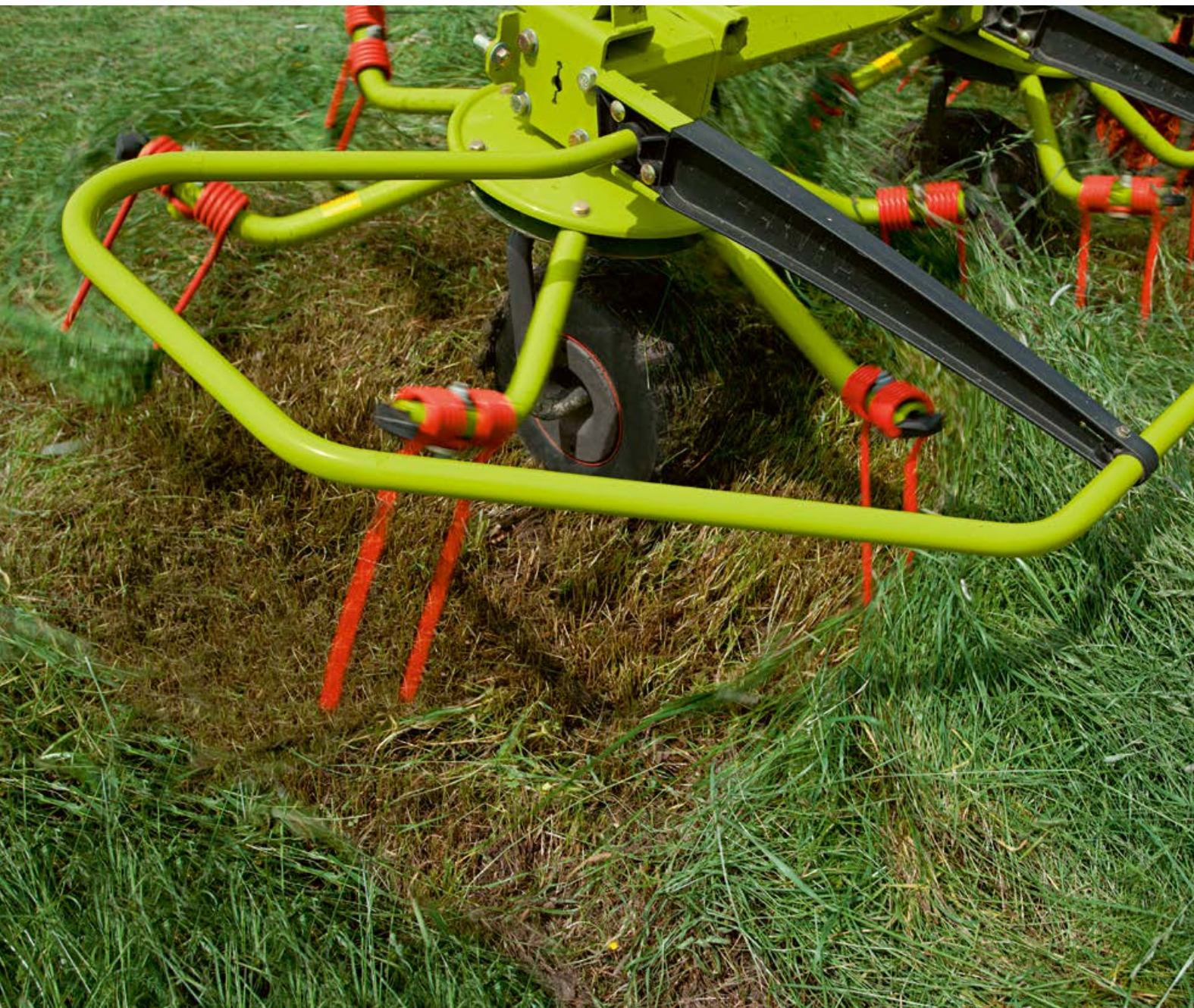
Ren räfsning: upptagning av materialet sker i små portioner.
