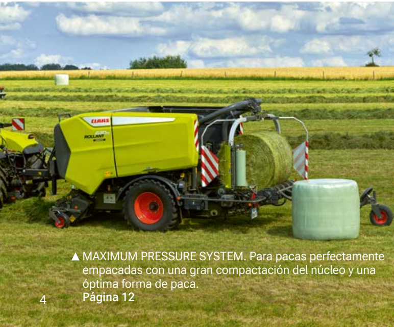
▲ El potente pick up MULTIFLOW, con una anchura de trabajo de 2,10 m, logra también grandes hileras de forma fiable. Página 8
