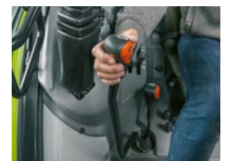
Mit REVERSHIFT Ausstattung: Bedienung der elektronischen Kuppelung per Knopfdruck am Schalthebel.
