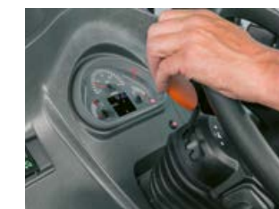
Die Wendeschtaltung erfolgt jeweils griffgünstig links neben dem Lenkrad, wahlweise elektronisch mit REVERSHIFT oder mechanisch.
