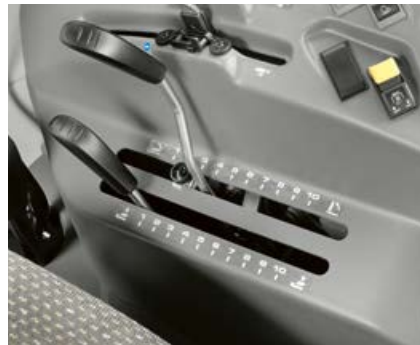
Die Bedienung der mechanischen Heckkraftheberregelung ist ergonomisch günstig rechts neben dem Fahrersitz platziert.
