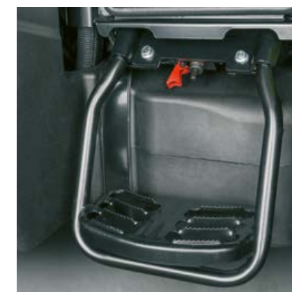
Der Batterietrennschalter ist griffgünstig am linken Einstieg platziert. (außer ELIOS 2.75)
