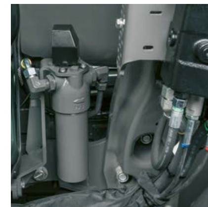
Die Filter am Motor sind auch mit Frontladerkonsolen gut erreichbar.
