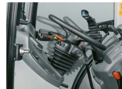
Die schwenk- und teleskopierbare Lenksäule lässt sich an die Sitzposition des Fahrers anpassen.
