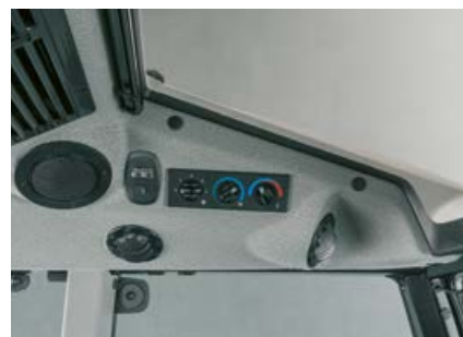
Die Heizungs- / Lüftungsanlage bietet ein vierstufiges Gebläse und zahlreiche einstellbare Luftdüsen. Eine regelbare Klimaanlage ist ebenfalls erhältlich.
