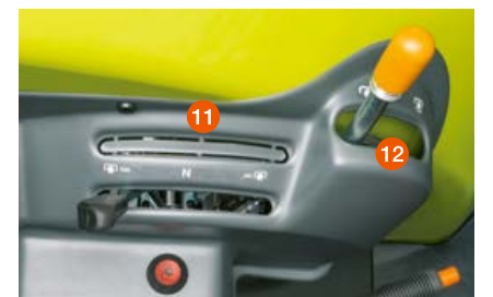
Die Zapfwelle wird serienmäßig hydraulisch unterstützt zugeschaltet. Bei Maschinen mit REVERSHIFT Ausstattung ist die elektronische Zapfwellenschaltung optional erhältlich.
