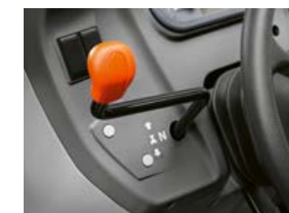
Die Wendeschtaltung erfolgt jeweils griffgünstig links neben dem Lenkrad, wahlweise elektronisch mit REVERSHIFT oder mechanisch.
