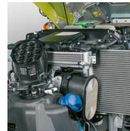
Der PowerCore®-Luftfilter ist gut zugänglich vorne unter der Motorhaube angeordnet und reduziert die Reinigungsintervalle.
