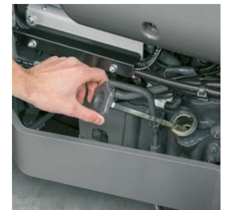
Ölstandskontrolle und Nachfüllen erfolgen bei geschlossener Haube an der rechten Seite des ELIOS 2.
