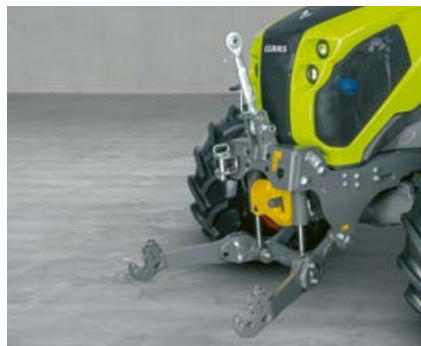
Der optionale Frontkraftheber mit 3,2 t Hubkraft und die Frontzapfwelle erweitern das Einsatzspektrum des ELIOS 2.
