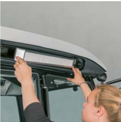
Piekluve gaisa filtram ir no ārpuses, un tas ļauj iztīrīt kabīnes filtru, lai nodrošinātu, ka gaiss kabīnē vienmēr būtu skaists.
