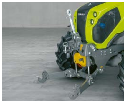
Priekšējā uzkare ar 3,2 t celbspēju un priekšējā jūgvārpsta (izvēles opcija) paplašina ELIOS 2 darbu diapazonu.
