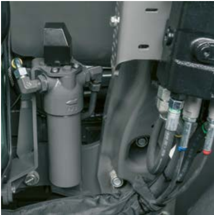
Filtriem dzinējā var viegli piekļūt par to, ja uzstādīts frontālā iekrāvēja rāmis.
