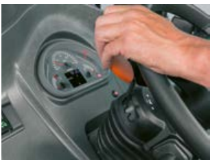
Vendegearet betjenes nemt og bekvemt til venstre for rattet, som ekstraudstyr elektronisk med REVERSHIFT eller mekanisk.
