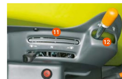
PTO-akslen tilkobles som standard hydraulisk understøttet. Elektronisk PTO-tilkobling fås som ekstraudstyr til maskiner med REVERSHIFT udstyr.
