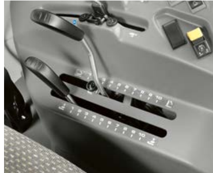
Betjeningen af den mekaniske bagliftregulering er placeret ergonomisk godt til højre for førersædet.
