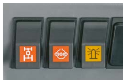
Elektronisk til- og frakobling af firehjulstræk og differentialespærre: Den hastighedsafhængige sikkerhedsafbrydelse betyder, at fejlbetjening undgås.
