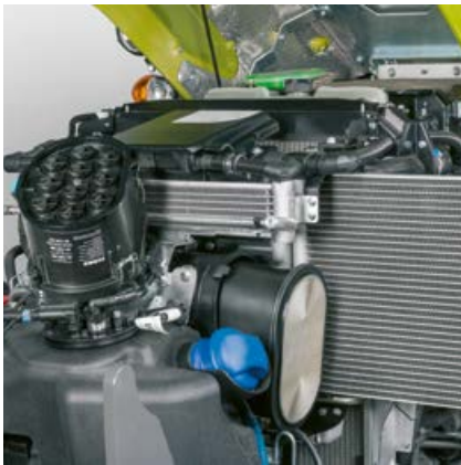
PowerCore®-luftfiltret er let at komme til med placeringen foran under motorhjelmen, hvilket reducerer rengøringsintervallerne.
