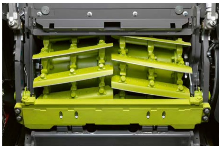
▲ Ostry bęben nożowy V-FLEX o szerokości 910 mm dokładnie tnie zbierany materiał. Elastyczne wyposażenie spełnia zróżnicowane wymagania. Strona 22
