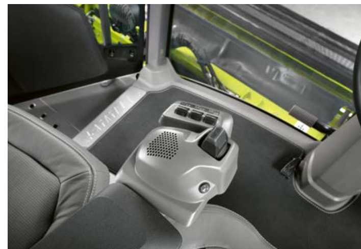
▲ Łatwe i wygodne manewrowanie: sterowanie joystickiem oraz dowolnie programowane przyciski funkcyjne znajdują się w lewym podłokietniku. Strona 40
