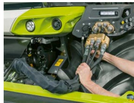
▲ Wielozłącza ułatwiają dołączenie.
