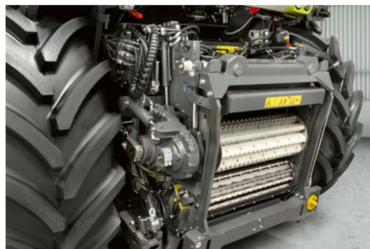
▲ Całkowicie hydrauliczne prasowanie wstępne umożliwia wysoką przepustowość we wszystkich zbieranych roślinach i długościach cięcia oraz zapewnia niezmiennie jednorodną jakość cięcia. Strona 20
