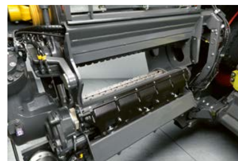
▲ Walce wstępnego prasowania można podnosić hydraulicznie na potrzeby prac konserwacyjnych.
