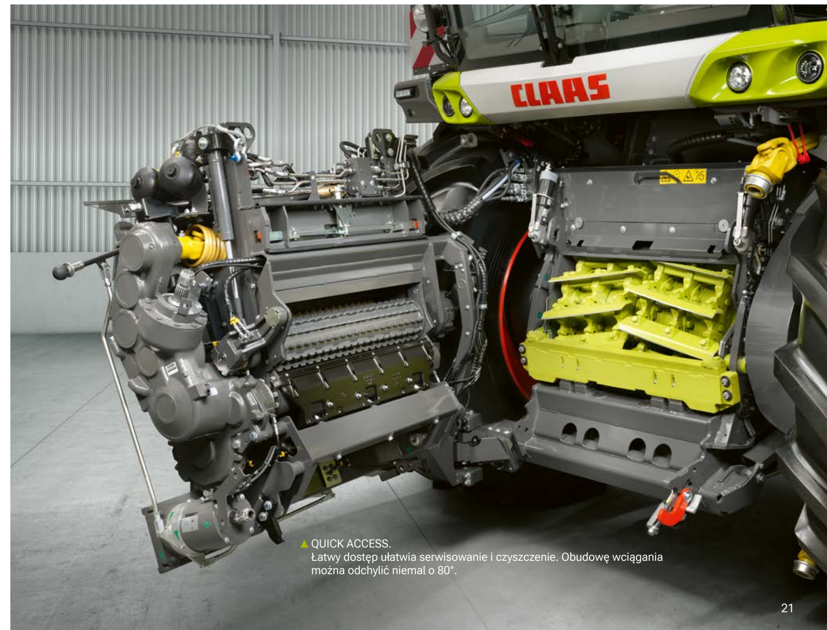
▲ Wahliwa rama zapewnia w sposób aktywny (hydraulicznie) lub pasywny (pozycja pływająca) wyrównanie boczne, aby optymalnie dopasować przyrządy robocze do podłoża.
