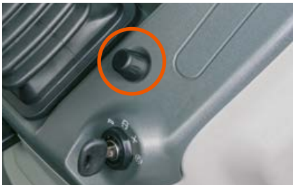
Izmantojiet grozāmo slēdzi, kas ir blakus stūrei, un ērti pārvietojieties pa izvēlni
