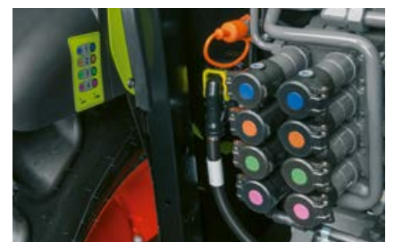
Aizmugurējie savienojumi ir viegli atpazīstami, pateicoties krāsu kodiem un blakus esošajām uzlīmēm.
