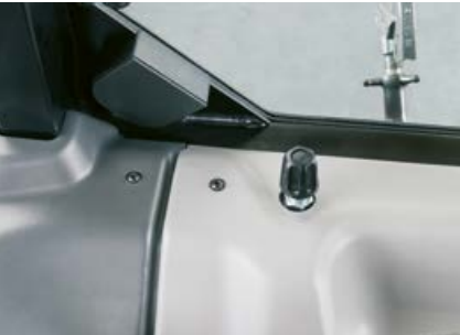
Mehāniski darbināmā hidroizvada nr. 3 maksimālo plūsmas ātrumu ir iespējams samazināt vienkārši ar roku, atrodoties kabīnē
