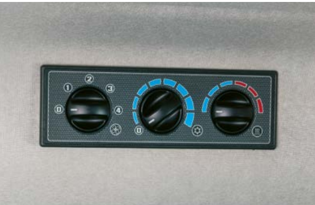
Gaisa kondicionēšanas vadības ierīces ir viegli aizsniiedzamas – tās atrodas pa labi, kabīnes griestu apšuvumā
