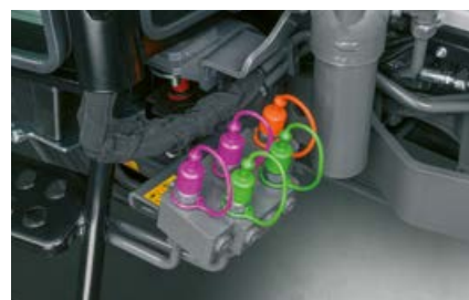
Priekšā ir pieejami pavisam četri hidrauliskie savienojumi un brīvas plūsmas atgrieze.
