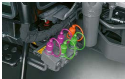
Sprijeda su dostupna do četiri hidraulička priključka i slobodan povrat.
