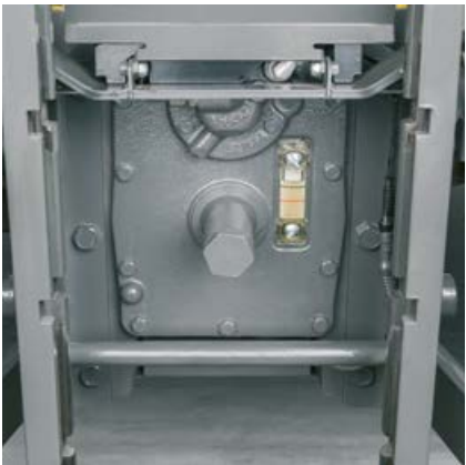
Oliestanden i gearkassen og hydraulikken kontrolleres med et kontrolglas ved siden af PTO'en bag.
