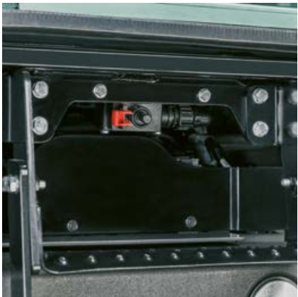
Batteriafbryderen er placeret lettilgængeligt ved indstigningen i venstre side.
