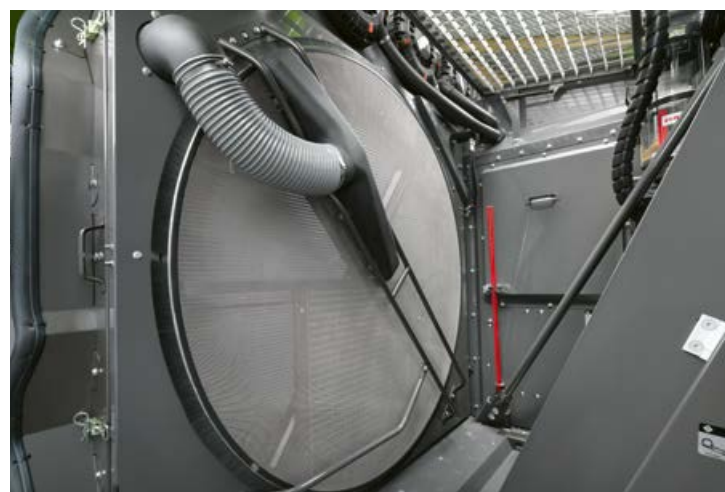
▲ Koel blijven tot 50°. Dankzij DYNAMIC COOLING wordt de JAGUAR afgestemd op de behoefte gekoeld. Bij werkzaamheden op het land en tijdens straatritten wordt de koelercorf permanent afgezogen. Pagina 35
