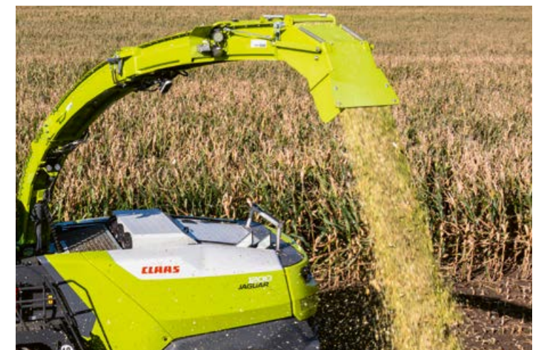
▲ De grote dwarsdoorsnede van de uitwerppijp is speciaal ontworpen voor een hoge en betrouwbare doorvoercapaciteit. Pagina 28
