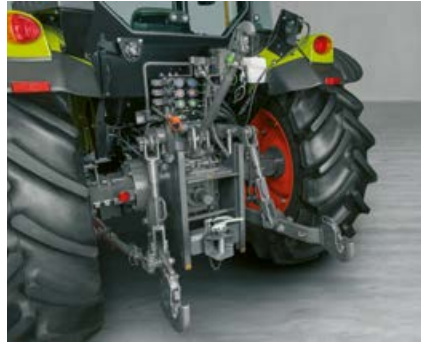
Mit 3,2 t maximaler Hubkraft kommt der ELIOS 2 im harten Alltag bestens zurecht.
