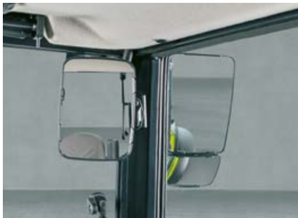
Zusätzlich zum großflächigen Spiegel ist ein Weitwinkelspiegel für mehr Sicherheit im Straßenverkehr verfügbar.
