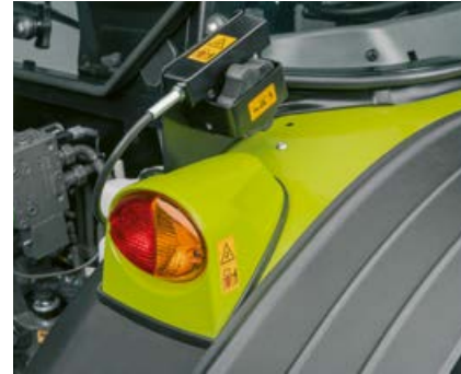
Die mechanische Heckkraftheberregelung kann zum Geräteanbau extern am Heck bedient werden.
