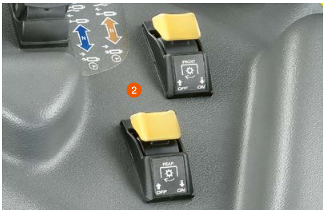
2 Front- und Heckzapfwelle lassen sich mit einem Knopfdruck einfach aktivieren.
