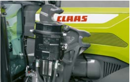
FITLOCK System zum schnellen An- / Abbau und MACH Schnellkuppler für elektrische und hydraulische Verbindungen.
