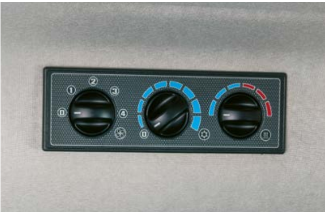
I comandi dell'impianto di ventilazione si trovano sul lato destro del tetto e sono facilmente raggiungibili.
