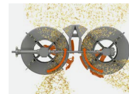
Radiaallaotur, mis laotab põhku tõhusalt ja minimaalse jõupingutusega.
