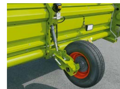
Kaks tugevat stabiliseerimisratast võimaldavad paremini maapinda järgida.
