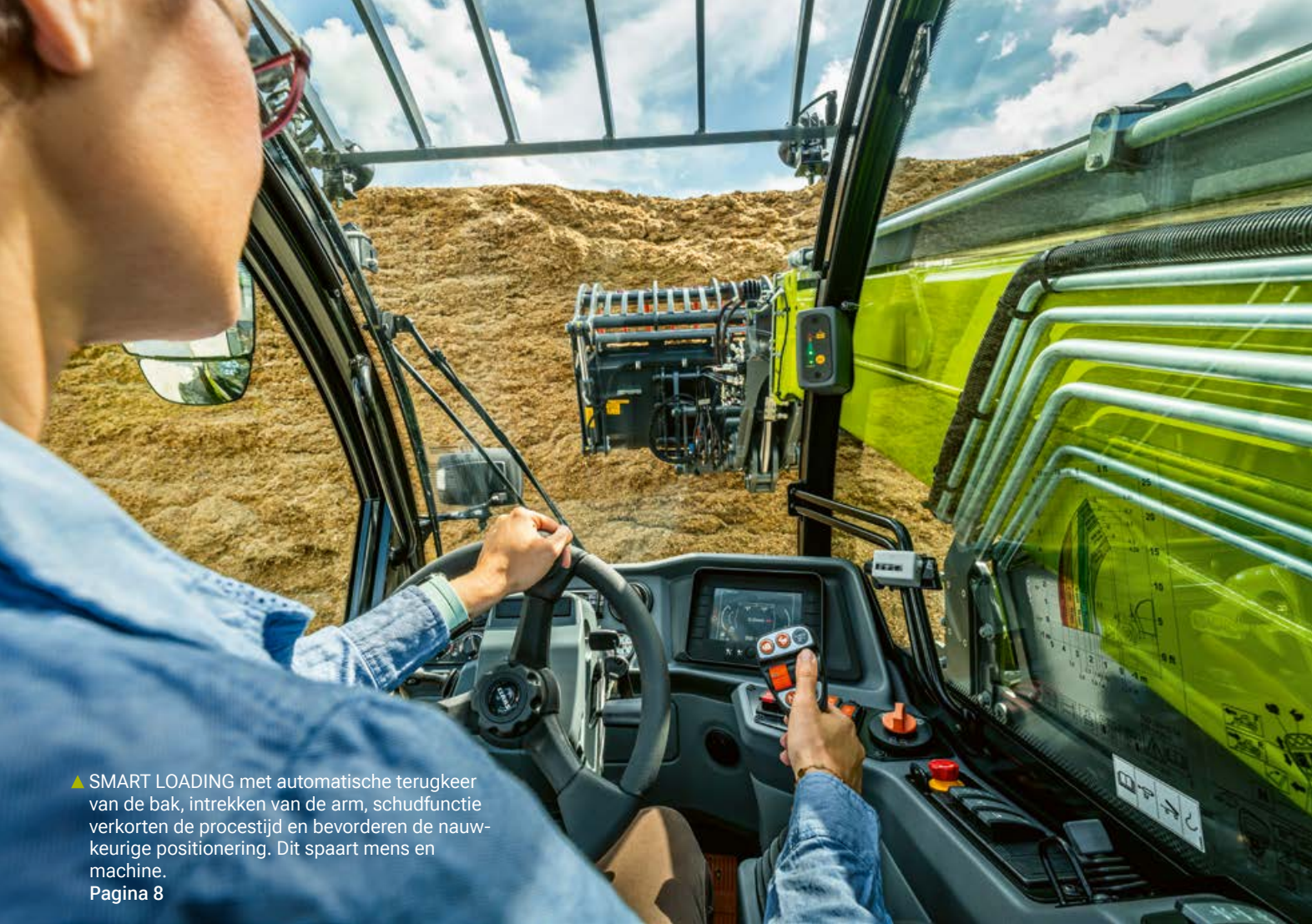
▼ Dankzij de krachtige hydrostatische transmissie rijdt u traploos van 0 tot 40 km/u. Dankzij de volledig geautomatiseerde transmissieregeling en intuïtieve bediening rijdt u met de SCORPION nauwkeurig en veilig bij elke snelheid. Pagina 14
