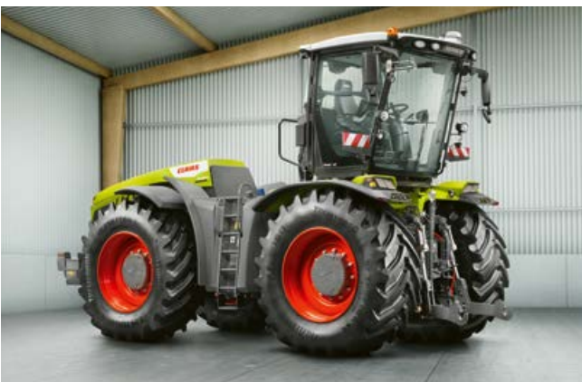
TRAC VC pune la dispoziție cel mai confortabil sistem cu cabină reversibilă de pe piață. Cabina sa poate fi rotită la 180° în mai puțin de 30 de secunde.
