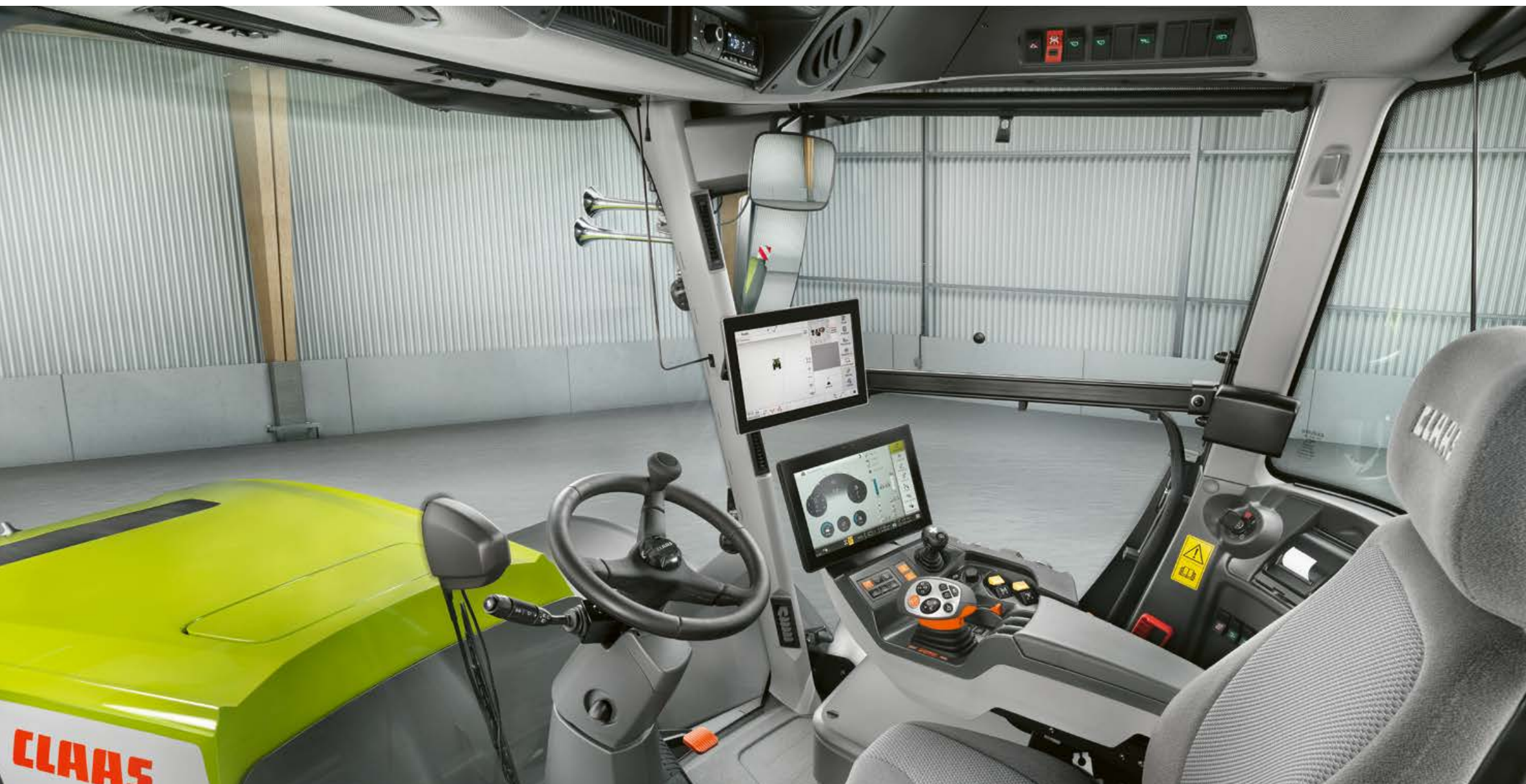
TRAC VC įrengta patogiausia rinkoje atbulinės eigos sistema. Kabiną galima pasukti 180° mažiau nei per 30 sekundžių.
