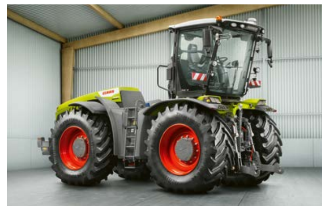
TRAC VC įrengta patogiausia rinkoje atbulinės eigos sistema. Kabiną galima pasukti 180° mažiau nei per 30 sekundžių.
