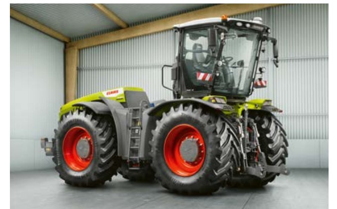
TRAC VC ma najbardziej komfortowy na rynku system jazdy tyłem. Kabinę można obracać o 180° w czasie krótszym niż 30 sekund.
