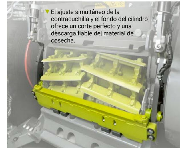
▼ El ajuste simultáneo de la contracuchilla y el fondo del cilindro ofrece un corte perfecto y una descarga fiable del material de cosecha.
