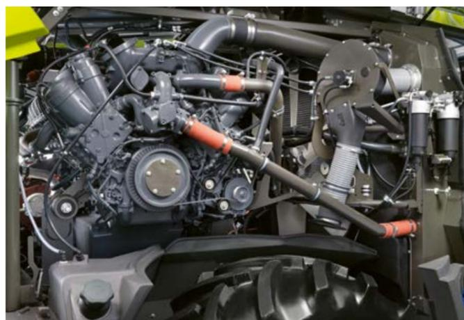
▲ El motor montado transversalmente transfiere la enorme potencia de hasta 1.110 CV de forma directa y eficiente. La potencia está perfectamente adaptada al ancho flujo de material y los cabezales. [Página 34](#)
