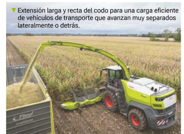
▼ Extensión larga y recta del codo para una carga eficiente de vehículos de transporte que avanzan muy separados lateralmente o detrás.
