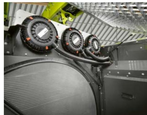
▲ Tres filtros de aire abastecen de forma fiable el potente motor. Para un rápido mantenimiento, se puede acceder a ellos sin herramientas.
