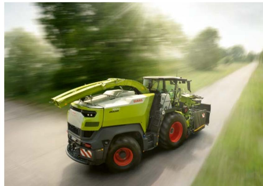
▲ El cambio entre el modo de trabajo y el modo de transporte se realiza rápida y fácilmente pulsando un botón. El codo 2XL es automáticamente girado, plegado y depositado de forma compacta en el apoyo del codo.
