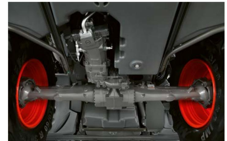
► El robusto eje directriz o eje directriz motriz detrás está preparado para una gran carga de hasta 10 t. Permite ser adaptado al ancho de vía con dos distanciadores de diferente ancho. Los sensores del ángulo de dirección se encuentran protegidos en el cuerpo del eje.
