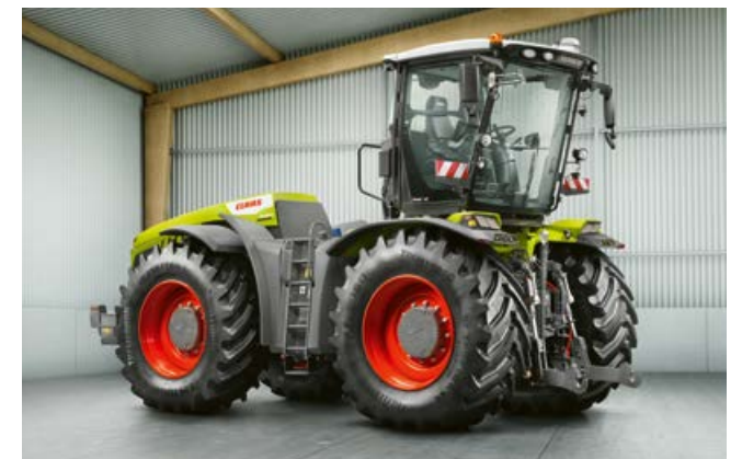
TRAC VC разполага с най-удобната система за движение на заден ход на пазара. Кабината му може да се завърти на 180° за по-малко от 30 секунди.
