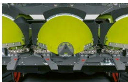
Gummimedbringare som skonsamt styr majscolvarna inåt för att minimera kolvspill.
