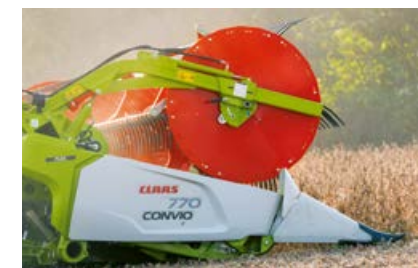
Stråskiljare med fjädrande upphängning för skörd av lågväxande grödor
