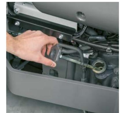
Ölstandskontrolle und Nachfüllen erfolgen bei geschlossener Haube an der rechten Seite des AXOS 2.
