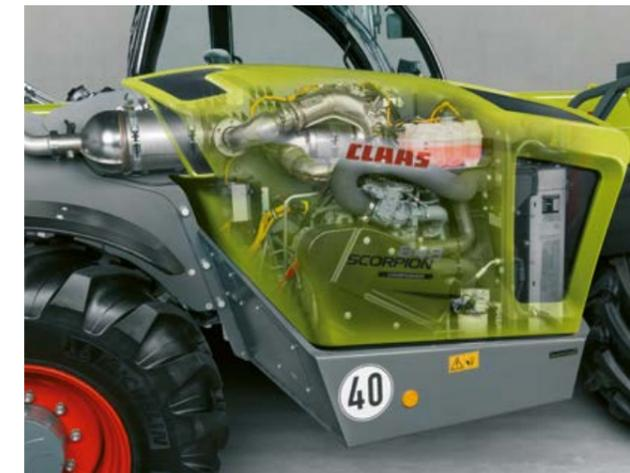
▲ L'air est aspiré à l'avant dans la zone propre et évacué vers le haut à l'arrière. Cela n'effraie pas les animaux et réduit en même temps la formation de poussière.
