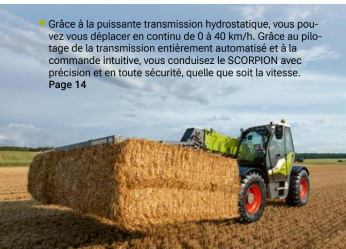
▼ Grâce à la puissante transmission hydrostatique, vous pouvez vous déplacer en continu de 0 à 40 km/h. Grâce au pilotage de la transmission entièrement automatisé et à la commande intuitive, vous conduisez le SCORPION avec précision et en toute sécurité, quelle que soit la vitesse.
