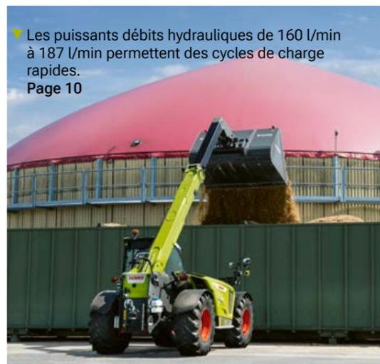
▼ Les puissants débits hydrauliques de 160 l/min à 187 l/min permettent des cycles de charge rapides.
