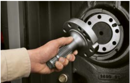
Embout de prise de force facilement interchangeable.
