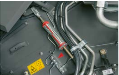
Points de graissage regroupés en bancs de graissage centralisés et parfaitement matérialisés
