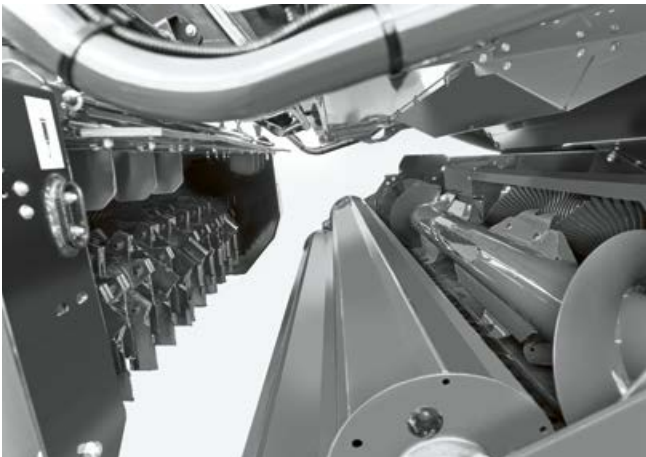
Le rotor à double spirale avec 88 couteaux assure une bonne qualité de coupe et un flux de récolte régulier pour une largeur de travail de 2 mètres. Les deux rangées de couteaux peuvent être réglées en plusieurs étapes avec 45 couteaux chacune comme contre-couteaux.
