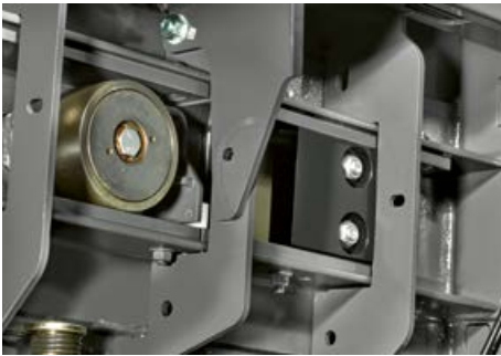
Les couteaux rotatifs peuvent être montés dans deux positions pour une utilisation dans la paille / la paille de maïs ou dans le foin / l'ensilage.
