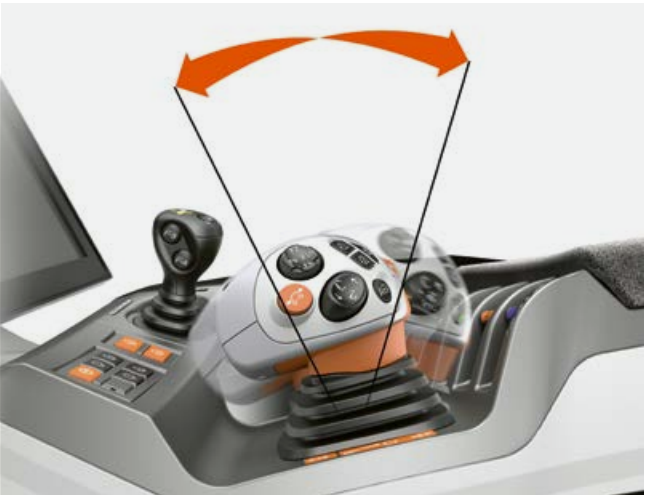
Commande progressive grâce à la technologie de transmission à variation continue CMATIC.
