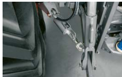
Les stabilisateurs latéraux hydrauliques en option contribuent à davantage de sécurité et facilitent le travail.
