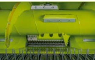
Accessoires : extensions lisses et grands galets de support
