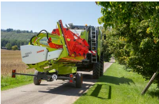
Même équipées de scies à colza, les barres de coupe VARIO affichent un gabarit réduit qui facilite leur transport sur route.
