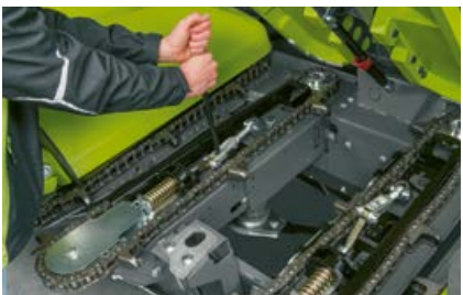
Correction facile de la tension des chaînes d'alimentation
