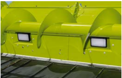
L'auge et la barre de coupe sont éclairées par des phares très puissants.
