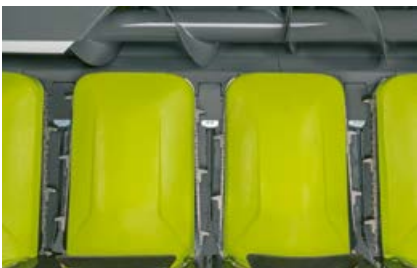
Plaques cueilleuses réglables par commande hydraulique
