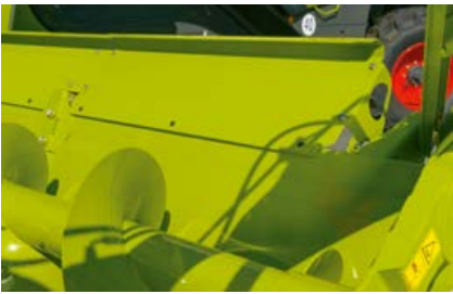
Réhausse d'auget additionnelle pour éviter les pertes par projection dans le colza
