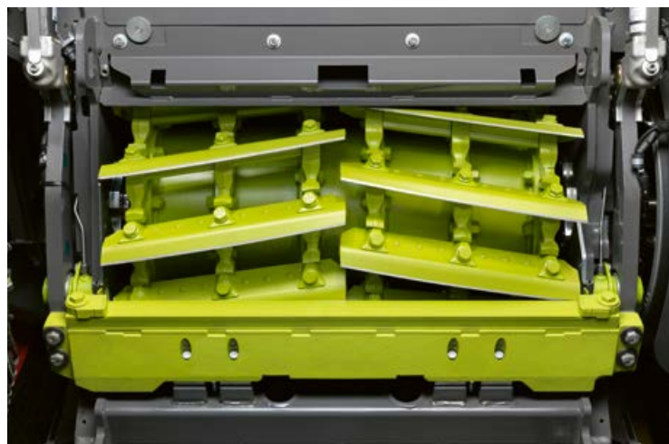
▲ Nožový buben V-FLEX o šířce 910 mm řeže sklizený materiál hladce a přesně. Tato flexibilní konfigurace splňuje širokou škálu požadavků. Strana 22
