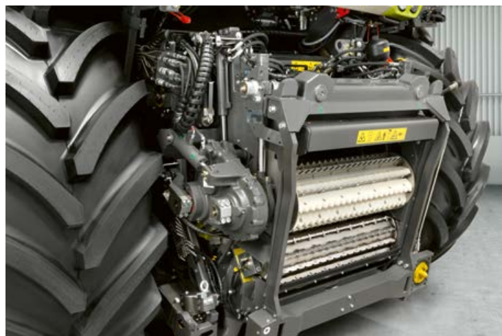
▲ Plně hydraulické předlisování umožňuje vysokou výkonnost u všech plodin a délek řezanky a zajišťuje konzistentně homogenní kvalitu řezanky. Strana 20
