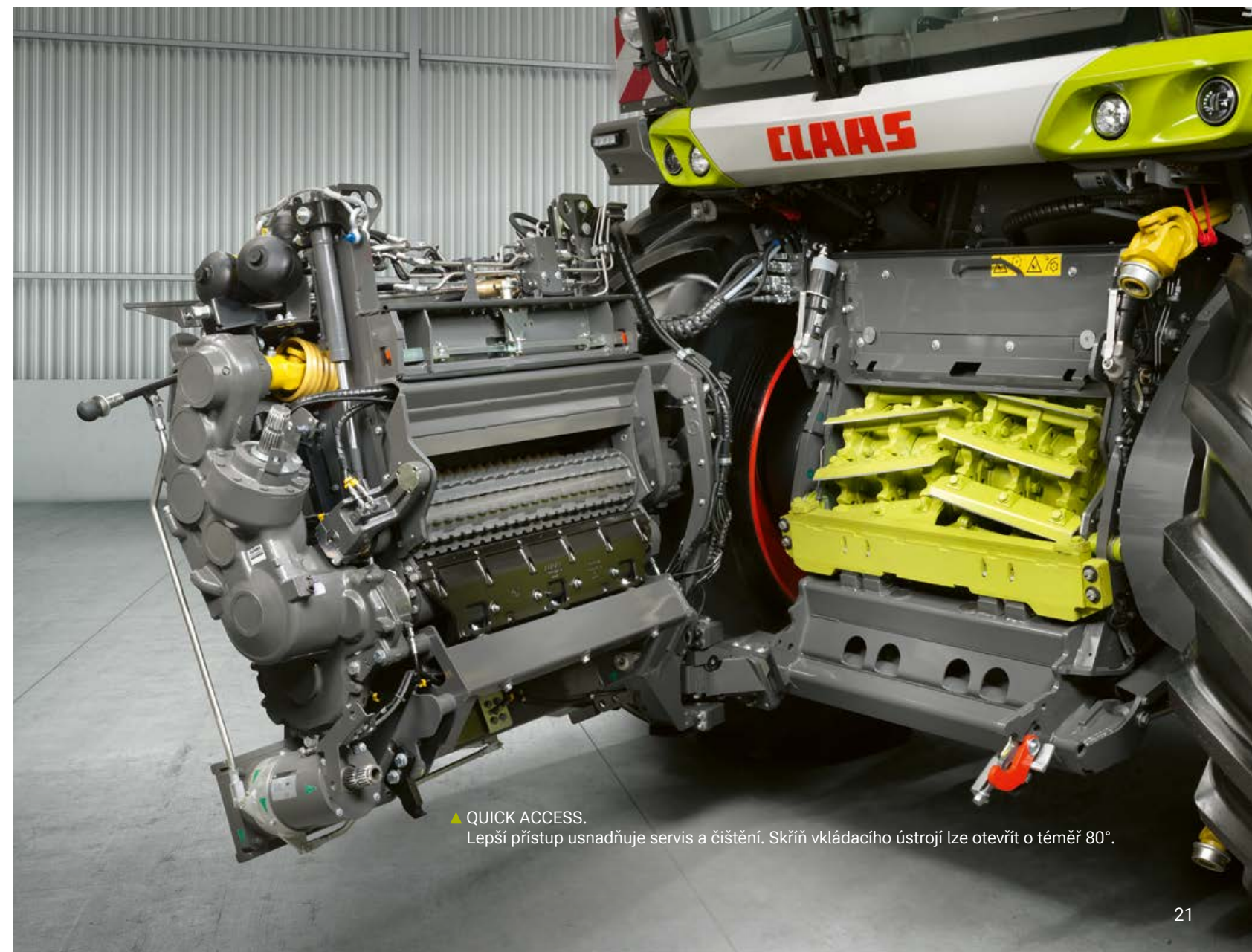
▲ Výkyvný rám umožňuje řízené aktivní (hydraulické) nebo pasivní (plovoucí poloha) boční vyrovnání pro optimální přizpůsobení předních sklizňových adaptérů terénu.
