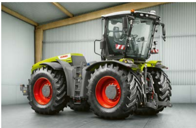
TRAC VC è dotato del sistema di guida reversibile più comodo disponibile sul mercato. La cabina può essere ruotata di 180° in meno di 30 secondi.
