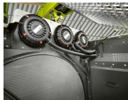
▲ Trois filtres à air font respirer le puissant moteur avec une grande fiabilité. Ils sont accessibles sans outil pour une maintenance rapide.
