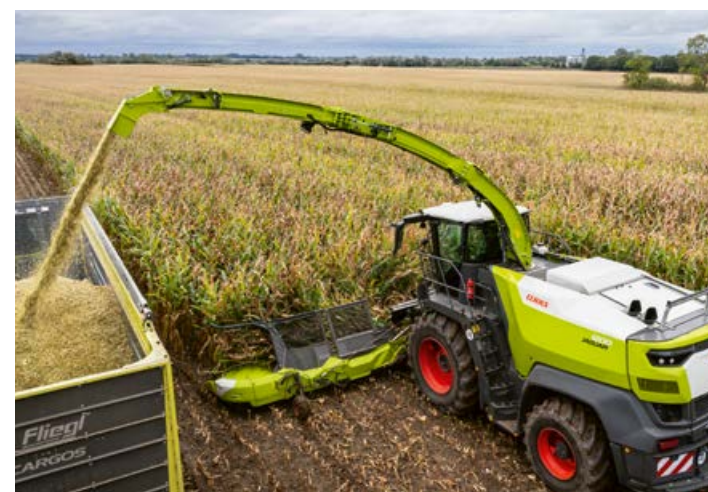
▲ Les outils frontaux de plus grande largeur comme l'ORBIS 10500 de 14 rangs transforment parfaitement la puissance du moteur en débit de chantier. Page 14
