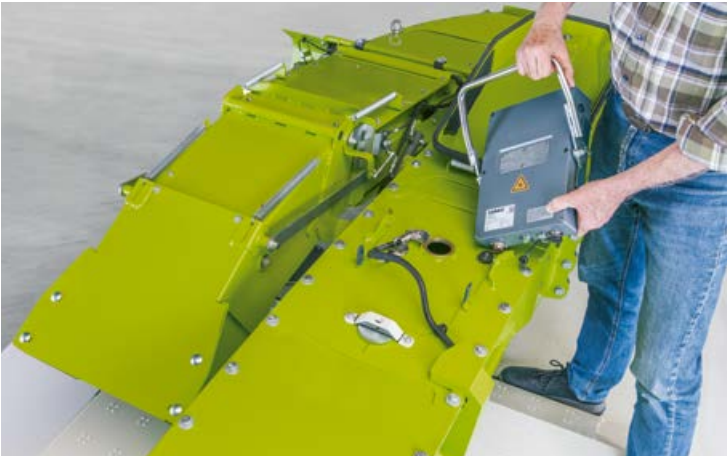
▲ Le capteur proche infrarouge NUTRIMETER analyse l'ensilage en temps réel et adapte automatiquement la longueur de coupe et le dosage des additifs d'ensilage selon le taux de matière sèche. Les données des ingrédients importants pour déterminer la qualité de la récolte sont enregistrées, affichées dans le CEMIS et disponibles via CLAAS connect.
