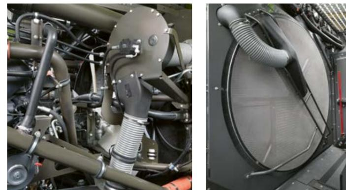
◀ Il grande filtro rotante del radiatore viene aspirato in continuo ed è possibile attivare la spazzola interna.
