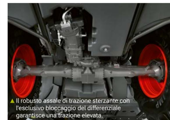
▲ Il robusto assale di trazione sterzante con l'esclusivo bloccaggio del differenziale garantisce una trazione elevata.
