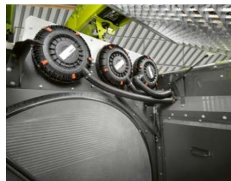
▲ Tre filtri dell'aria alimentano in modo affidabile il potente motore e sono accessibili senza attrezzi per una rapida manutenzione.
