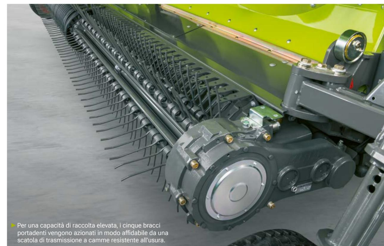
► Per una capacità di raccolta elevata, i cinque bracci portadenti vengono azionati in modo affidabile da una scatola di trasmissione a camme resistente all'usura.
