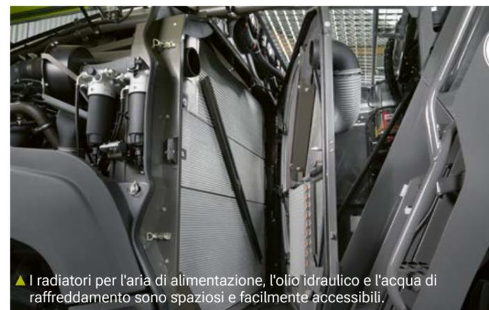
▲ I radiatori per l'aria di alimentazione, l'olio idraulico e l'acqua di raffreddamento sono spaziosi e facilmente accessibili.
