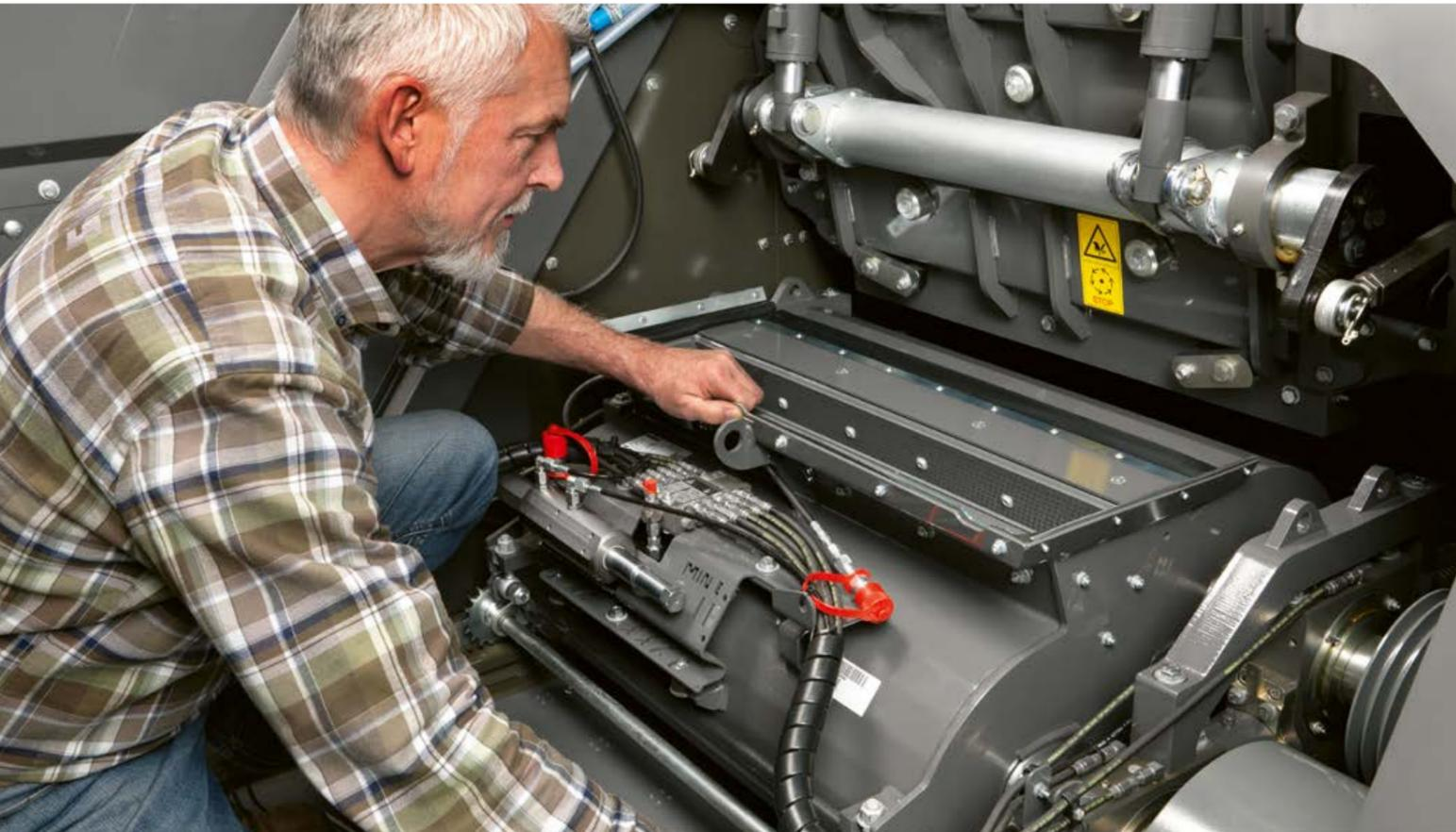
▲ Ampi sportelli laterali consentono un facile accesso, ad esempio, per il montaggio e lo smontaggio del corn cracker o la pulizia senza attrezzi dei tre grandi filtri dell'aria.
