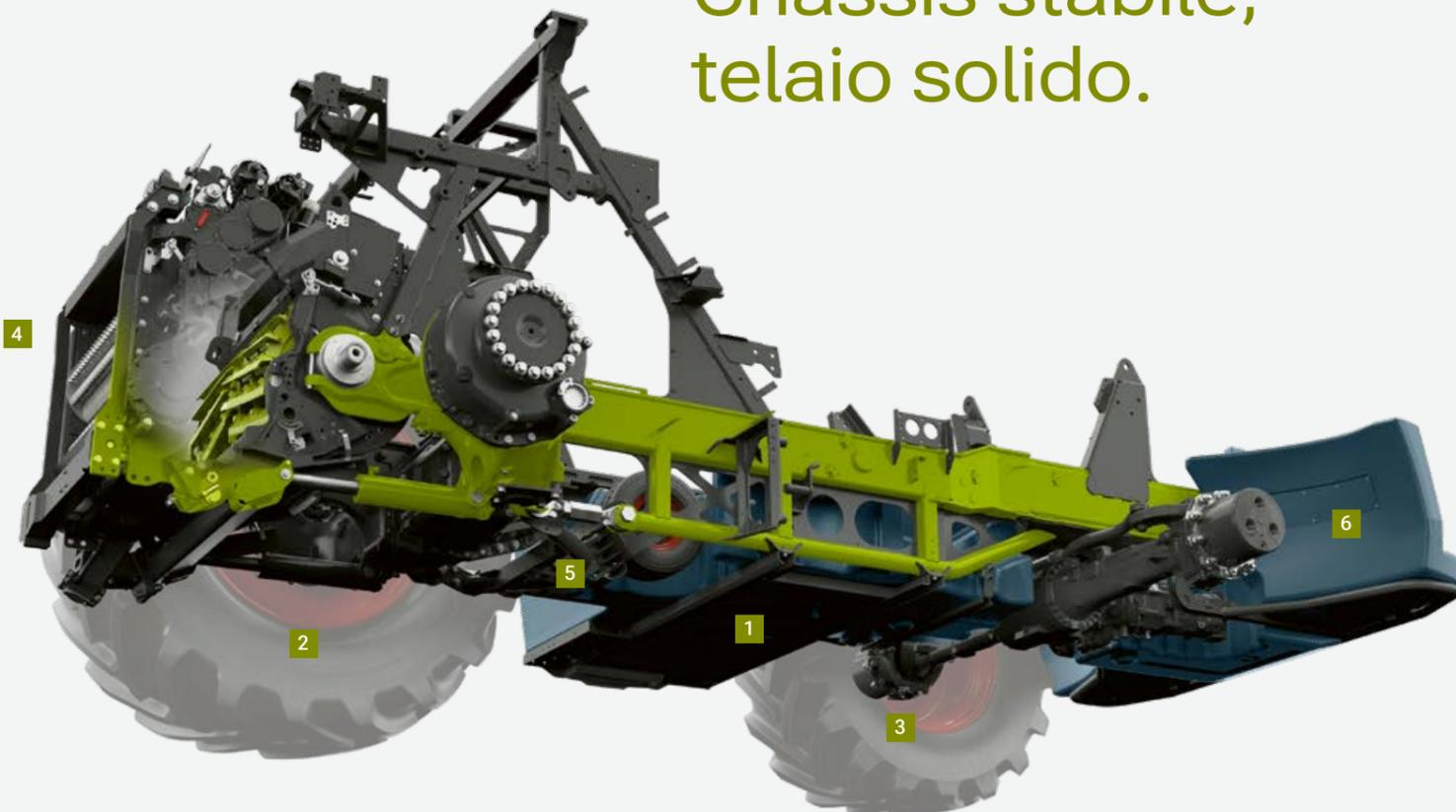
1. Robusto chassis con sottostruttura che assorbe il carico
