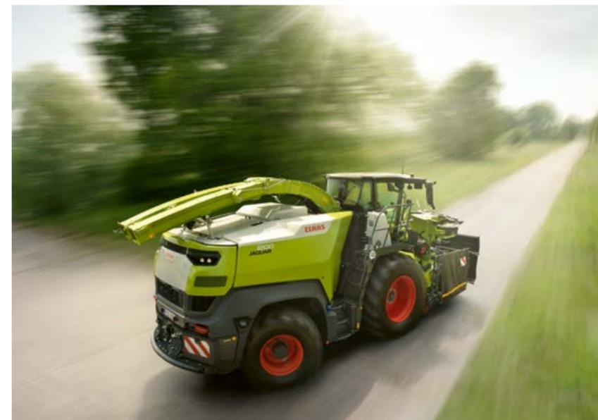
▲ Il passaggio dalla modalità di lavoro alla modalità di trasporto si effettua in modo semplice e veloce premendo un pulsante. Il tubo 2XL viene automaticamente inclinato, ripiegato e posizionato in modo compatto sull'apposito supporto.
