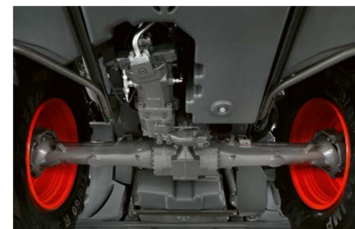
► Il robusto assale sterzante o assale di trazione sterzante posteriore è progettato per carichi elevati fino a 10 t. La larghezza della carreggiata può essere regolata tramite due distanziatori di diversa larghezza. I sensori dell'angolo di sterzo si trovano, protetti, nel corpo dell'assale.
