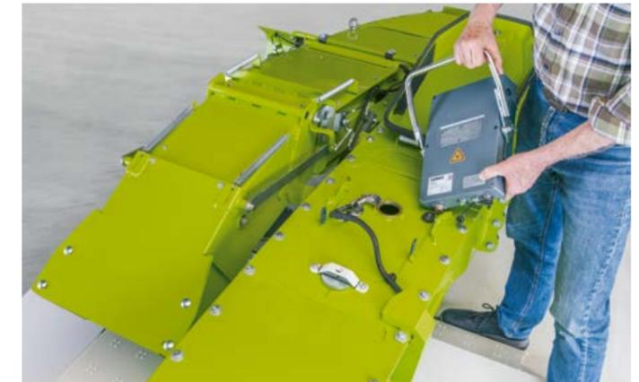
▲ Il sensore NIR vicino CLAAS NUTRIMETER, analizza in tempo reale il vostro trinciato e adegua automaticamente, a seconda del contenuto di sostanza secca, la lunghezza di taglio e il dosaggio dell'additivo per insilato. I componenti principali vengono rilevati per determinare la qualità del prodotto, visualizzati come dati nel CEMIS e resi accessibili tramite CLAAS connect.
