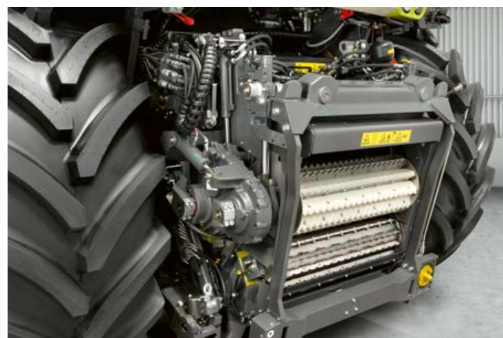
▲ Напълно хидравличното предварително пресоване позволява висока производителност при всички видове култури и дължини на рязане и осигурява постоянно хомогенно качество на нарязването. Страница 20
