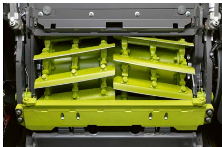
▲ Ножовият барабан V-FLEX с ширина 910 mm отрязва културата остро и прецизно. Гъвкавото оборудване отговаря на най-различни изисквания. Страница 22
