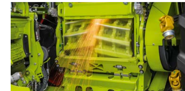
Slijpen en instellen van het tegenmes neemt nauwelijks tijd in beslag.
