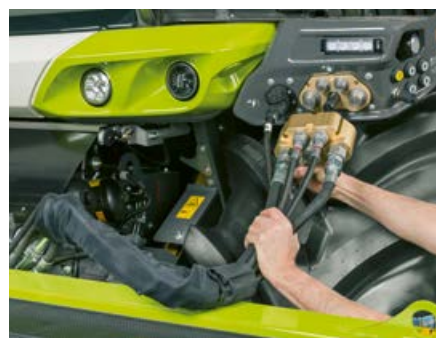
▲ Multikobling for nemmere tilslutning.
