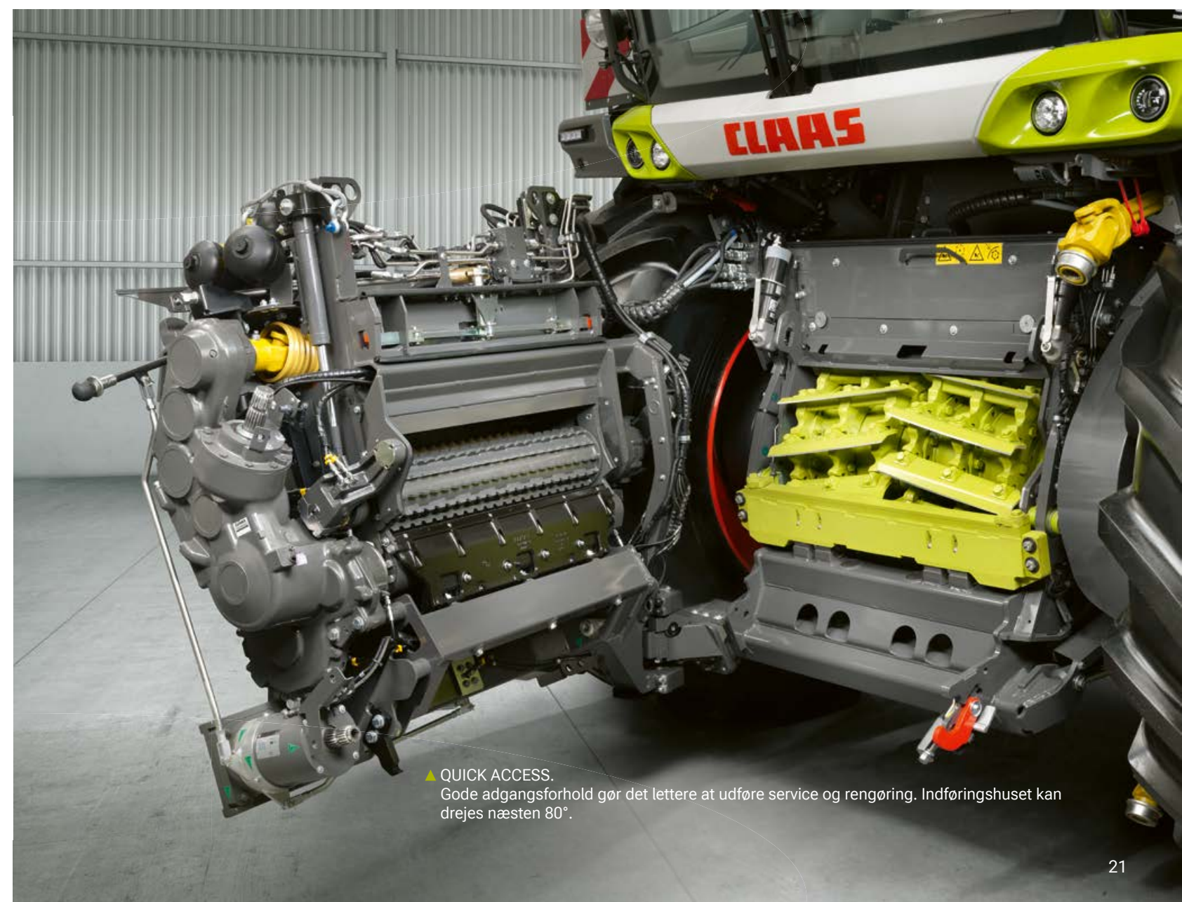
▲ Pendulrammen sidejusterer aktivt (hydraulisk) eller passivt (svømme-position) for at tilpasse frontudstyret optimalt til underlaget.
