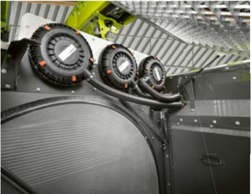
▲ Tre luftfiltre forsyner den kraftfulde motor. Adgangen uden brug af værktøj gør, at vedligeholdelse kan klares hurtigt.
