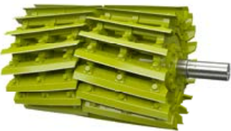
▲ Fuld knivbestykning for korte til mellemlange snitlængder.
