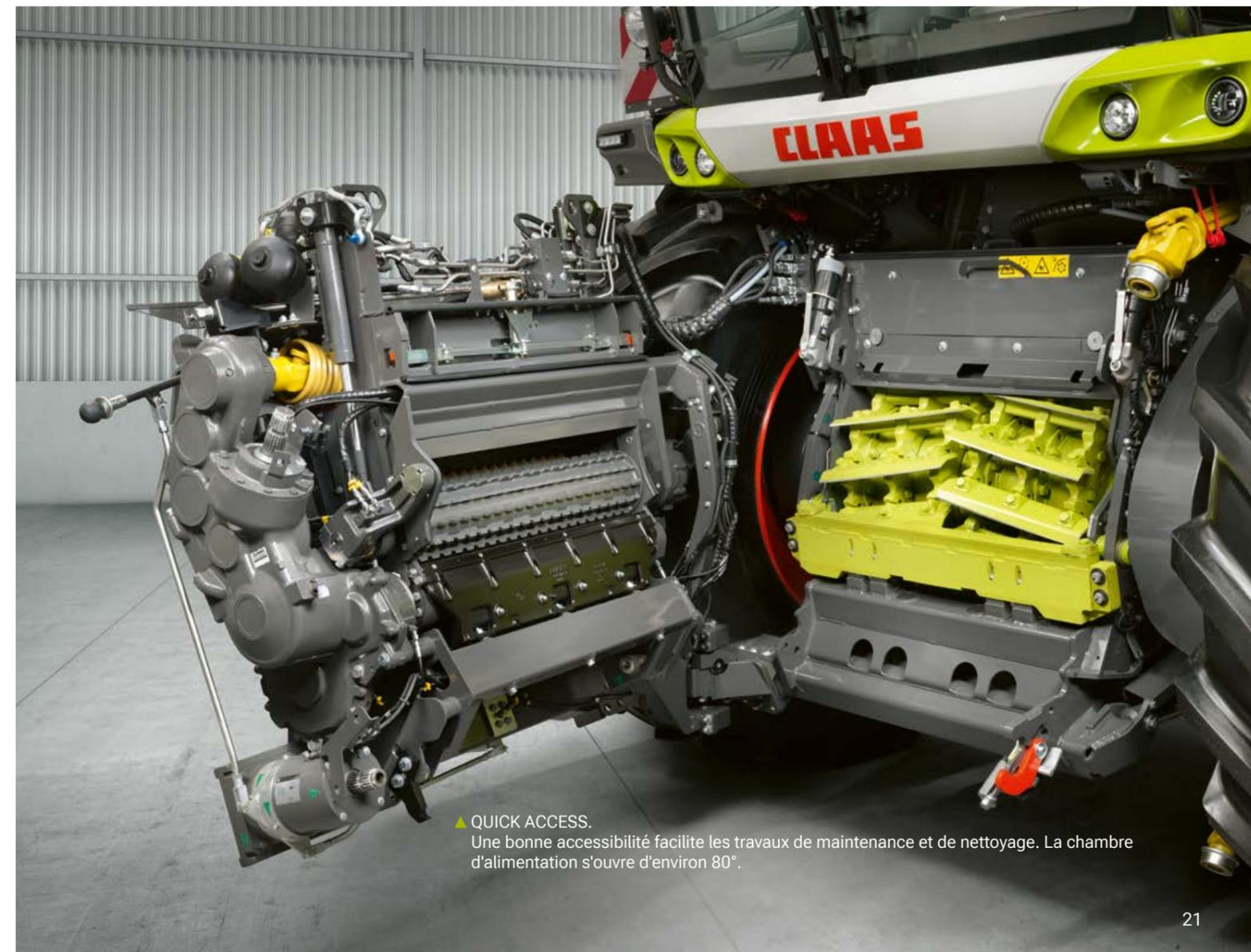
▲ **QUICK ACCESS.** Une bonne accessibilité facilite les travaux de maintenance et de nettoyage. La chambre d'alimentation s'ouvre d'environ 80°.
