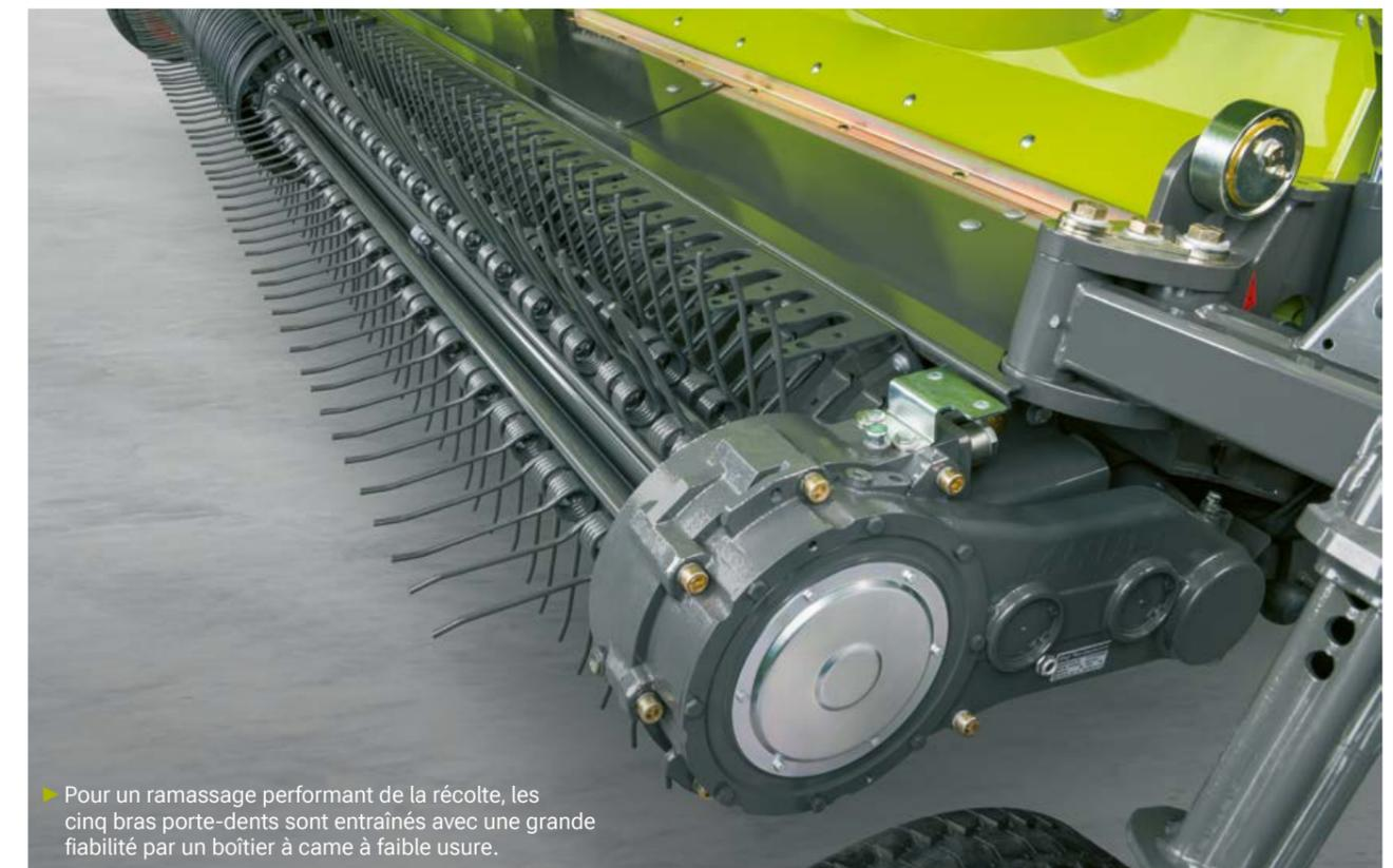
► Pour un ramassage performant de la récolte, les cinq bras porte-dents sont entraînés avec une grande fiabilité par un boîtier à came à faible usure.
