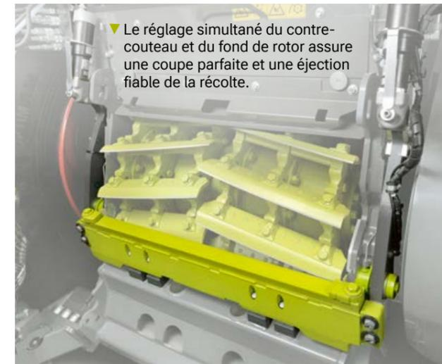
▼ Le réglage simultané du contre-couteau et du fond de rotor assure une coupe parfaite et une éjection fiable de la récolte.
