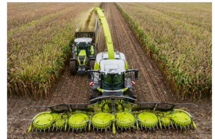
▲ Le moteur en position transversale assure une transmission directe et efficace de son énorme puissance (jusqu'à 1 110 ch). Celle-ci est parfaitement adaptée au flux de récolte et aux outils frontaux de grande largeur. [Page 34](#)
