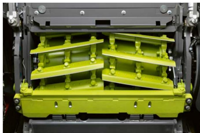
▲ Le rotor V-FLEX de 910 mm de large assure une coupe franche et précise de la récolte. Les différentes configurations de couteaux permettent de s'adapter à tous les besoins. [Page 22](#)
