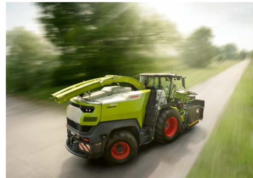
▲ La commutation entre le mode de travail et le mode de transport s'effectue rapidement et simplement par simple pression sur un bouton. La goulotte 2XL pivote et se replie automatiquement de façon compacte sur son support.
