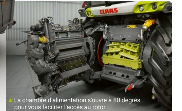
▲ La chambre d'alimentation s'ouvre à 80 degrés pour vous faciliter l'accès au rotor.
