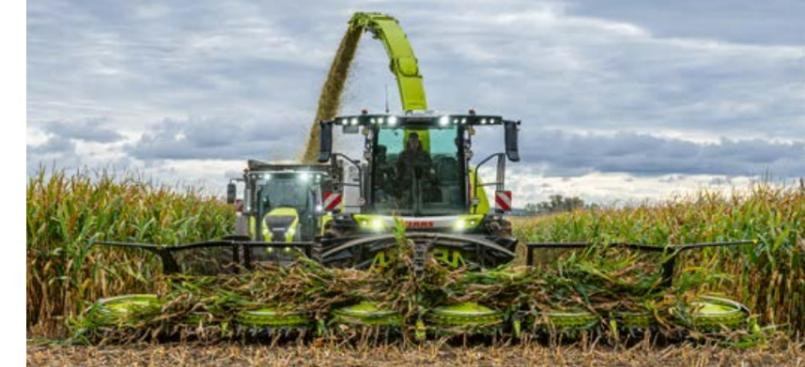
▼ L'AUTO CONTOUR et les roues stabilisatrices à pilotage actif guident avec précision et en douceur le bec à maïs sur le sol.
