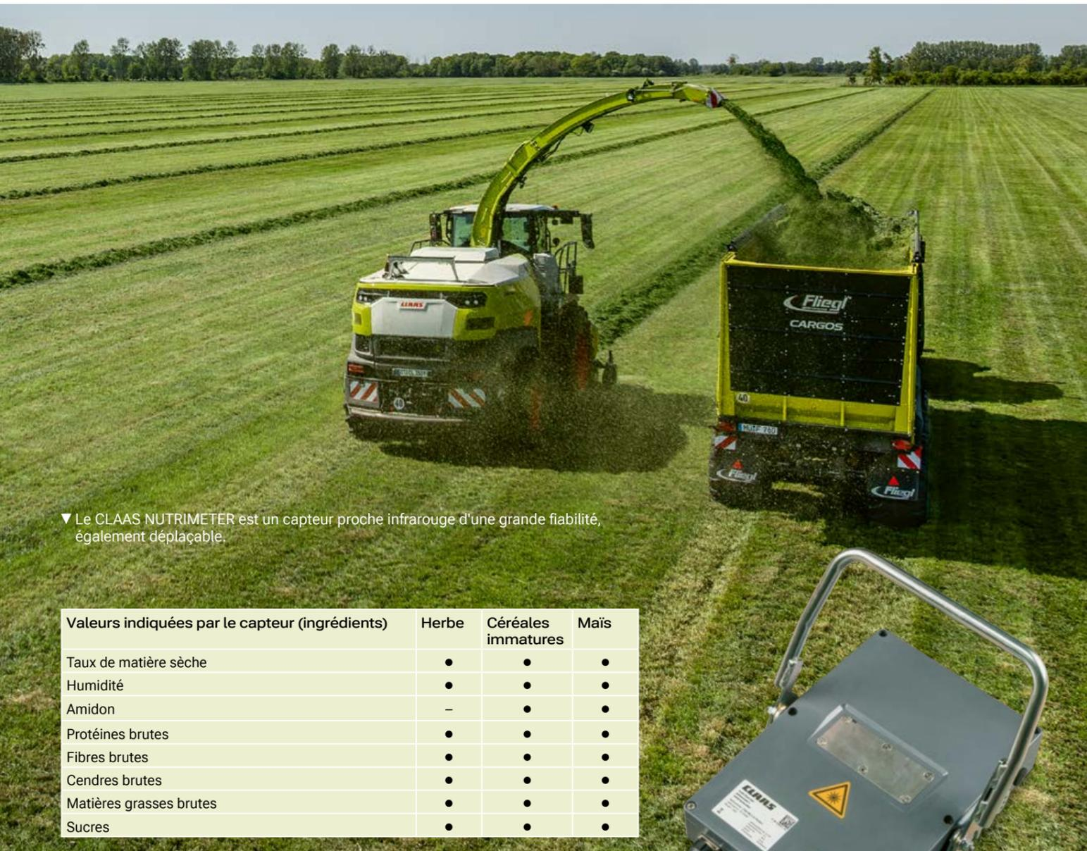
▼ Le CLAAS NUTRIMETER est un capteur proche infrarouge d'une grande fiabilité, également déplaçable.
