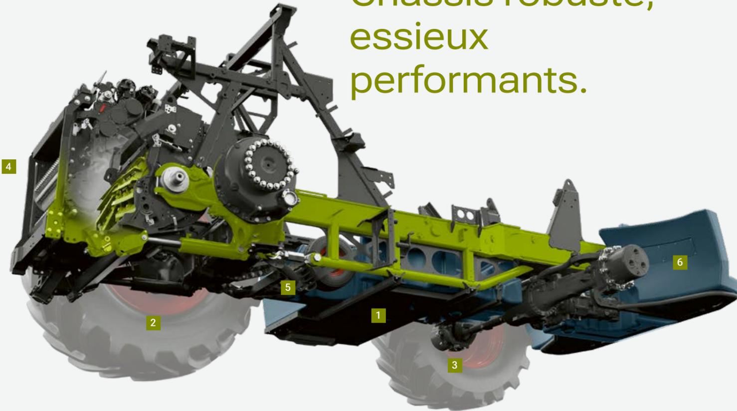
1. Châssis robuste avec bas de caisse extrêmement résistant
