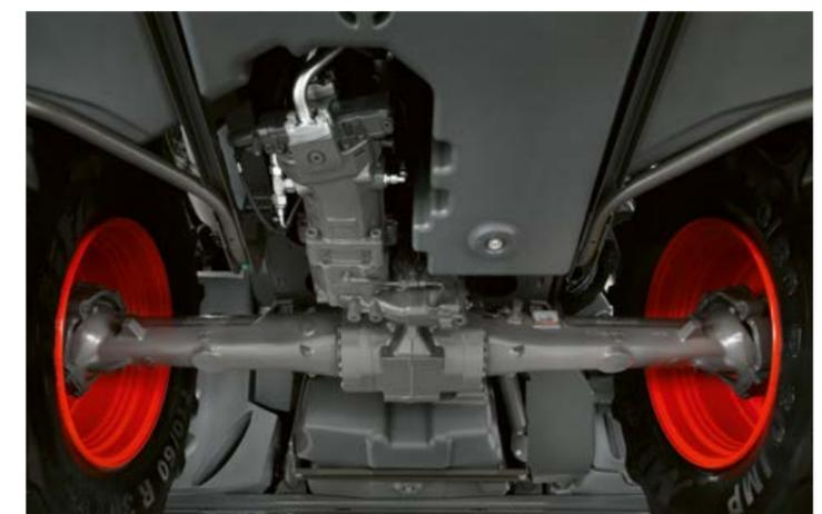
► L'essieu directeur et l'essieu directeur moteur robustes à l'arrière peuvent supporter des charges jusqu'à 10 t. Le pont arrière prévoit la possibilité d'élargissement de la voie avec des entretoises. Les capteurs d'angle de braquage sont intégrés et protégés dans le corps d'essieu.
