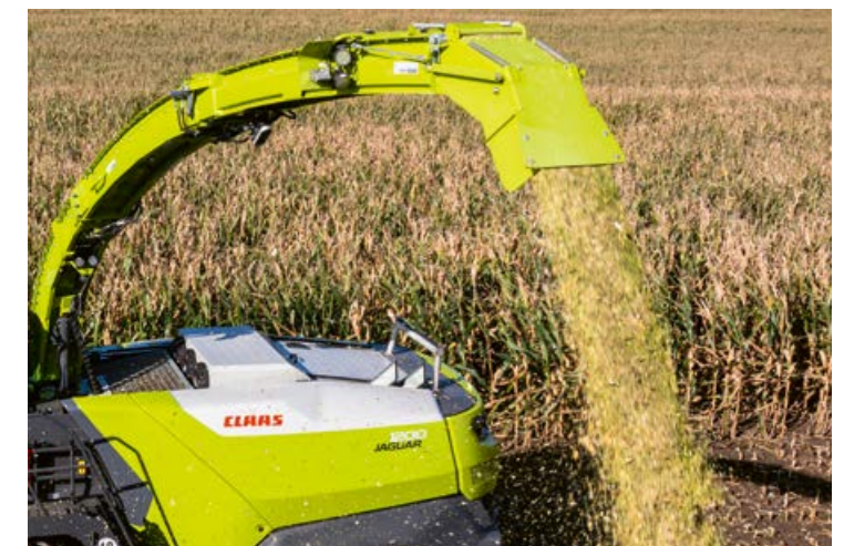
▲ Con su gran diámetro, el codo de descarga está preparado para un caudal de procesamiento alto y fiable. Página 28
